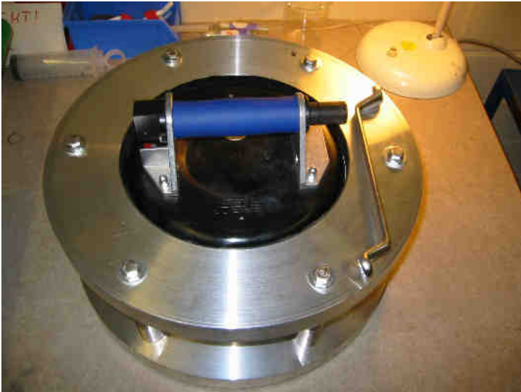
Abbildung 3.13: Der Vakuumsauger mit der Drehkammer
